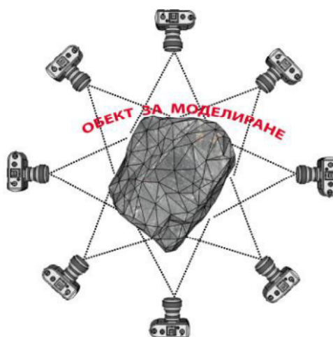
Фиг. 1. Множество застъпващи се изображения от различни ъгли и разстояния, за да се реши тримерността на обектите и повърхностите.
