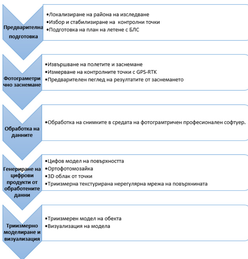
Фиг. 4. Работен процес за триизмерно моделиране чрез използване на БЛС
